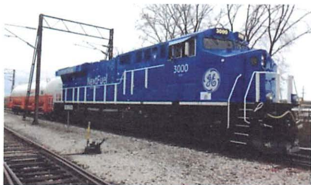
Figure 17 – GECX3000 and LNG tender
